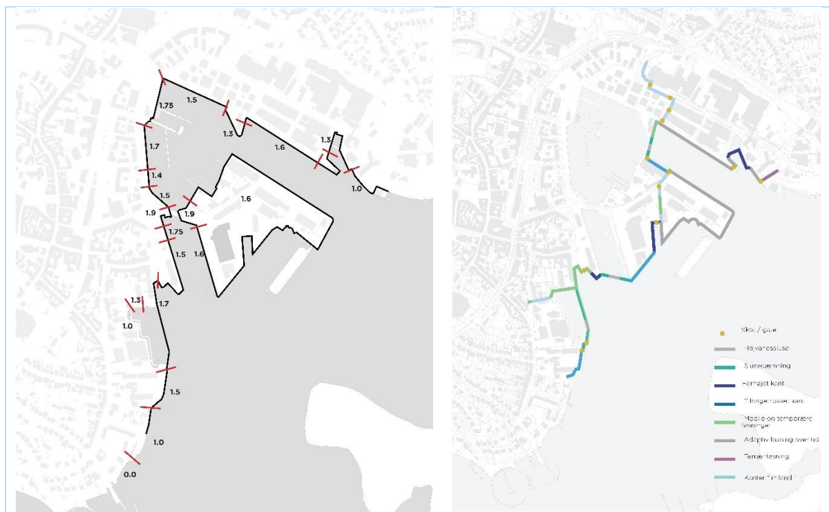
Figur 11 T.v. Eksisterende kajkanter og t.h. sikringstyperne ind til kote +3 m DVR90.
